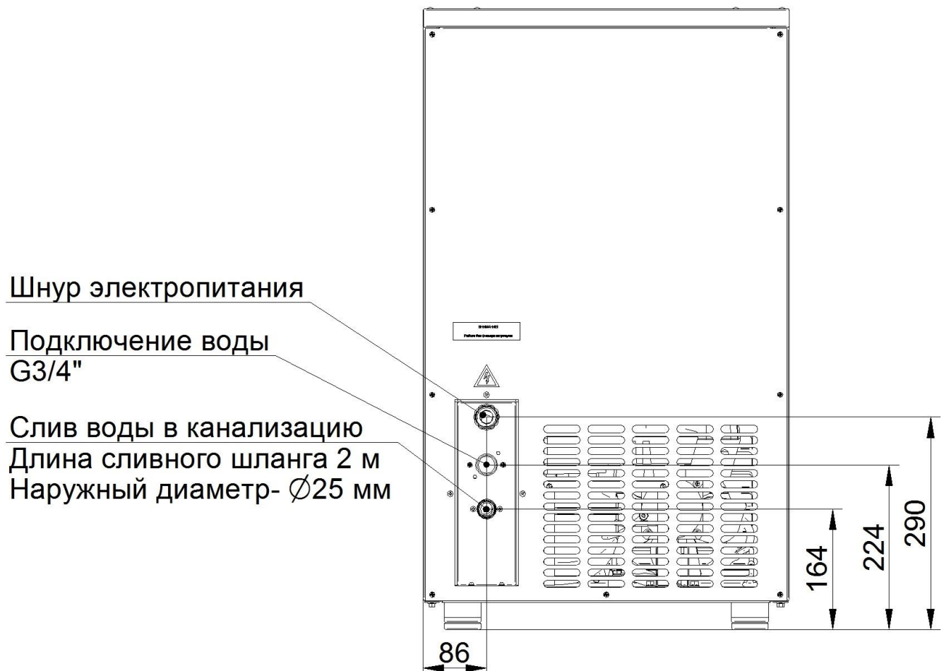
Рис. 4 Схема подключения льдогенератора
